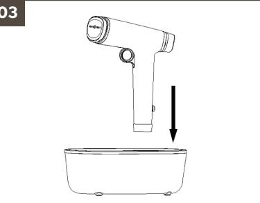
+ Nach dem Aufheizen wird die blaue Anzeigenleuchte kontinuierlich leuchten. Währenddessen können Sie die Haupteinheit vom Behälterboden abnehmen, die Dampftaste wie mit dem Pfeil angezeigt gedrückt halten und für die Pflege Ihrer Kleidung je nach Bedarf Dampf aussprühen.
