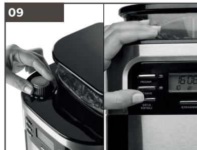
"AÇMA/KAPAMA" düğmesine bir defa basın. 3 saniye sonra öğütücü, kahve çekirdeklerini öğütmeye başlayacaktır. Öğütme işlemi bittikten 3 saniye sonra ise LCD ekranда fincan resmi görünecek ve kahve demleme işlemi başlayacaktır. (Resim 10)
