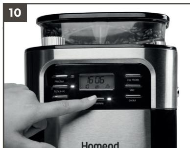
Das Tassenbild auf dem LCD-Display verschwindet, wenn der Brühvorgang beendet ist. Wenn Sie das Gerät nach Beendigung des Brühvorgangs nicht ausstecken, bleibt der Kaffee noch eine Weile in der Kanne heiß. Das Gerät schaltet sich dann automatisch aus.
