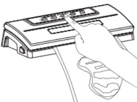
4. Wenn die VERSIEGELUNG-Kontrollleuchte erlischt, ist der Vorgang abgeschlossen. Drücken Sie den Knopf an beiden Enden, um der Abdeckung zu öffnen und den versiegelten Beutel zu entfernen.
