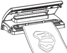
2. Schließen Sie der Abdeckung und drücken Sie auf beide Enden der Abdeckung. Wenn der Deckel richtig einrastet hören Sie ein "Klick"-Geräusch.
